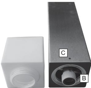
6. Legen Sie den O-Ring **B** so auf den Aluring, dass er zwischen dem Glas und dem Bund abdichtet. Setzen Sie nun das passende Leuchtmittel mit maximal 23 Watt in die vorgesehene Fassung.
